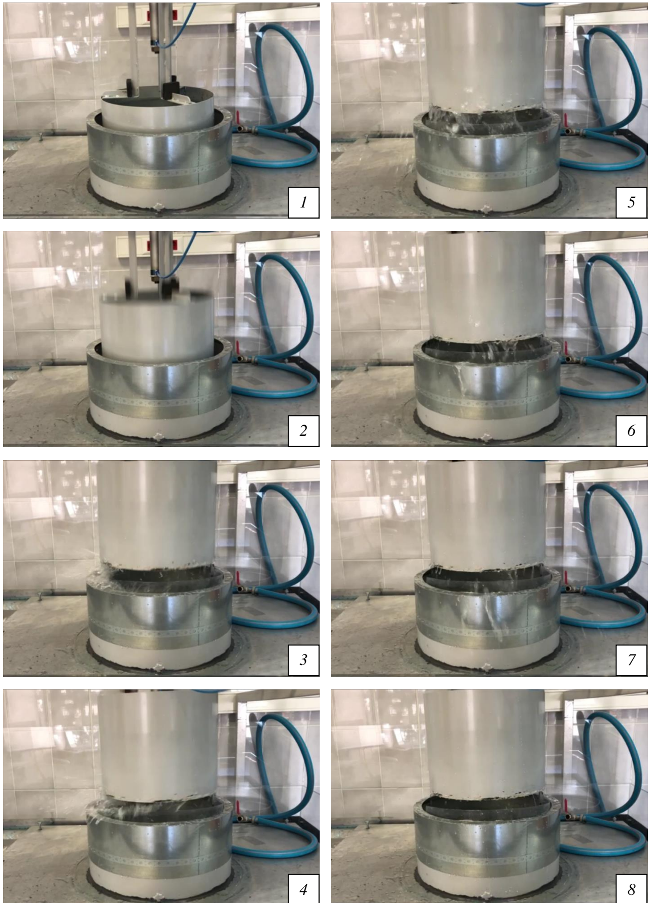
Рисунок 2.28 – Характерные кадры взаимодействия потока жидкости при разрушении резервуара в масштабе 1:60 к натурному РВС-5000 м 3 с защитной стенкой с ГВК ( h_0 = 0,25 м; l = 0,05 м; b_{ГВК} = 0,025 м)
